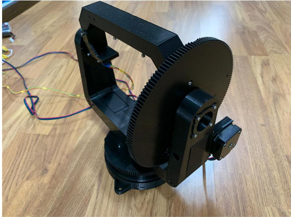
**Figura 5.17:** Resultado general del montaje de la estructura de la antena
