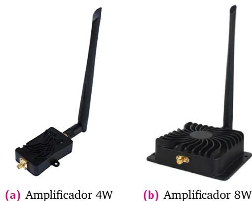
**Figura 5.13:** Amplificador al cual se conecta la antena WiFi
