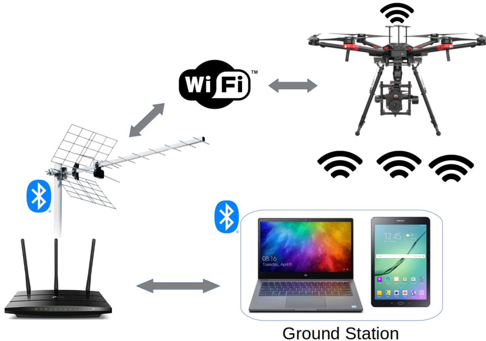
**Figura 4.2:** Esquema de comunicaciones de la plataforma
