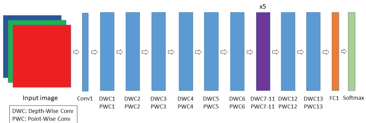
Figura 1.4: Estructura de la red Mobilenet
