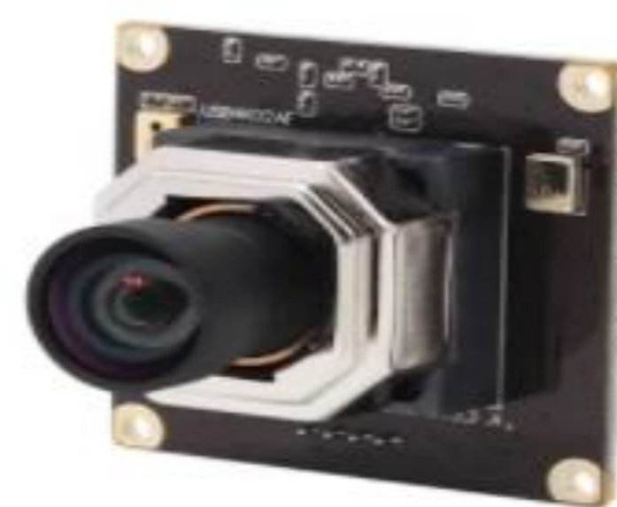
Cámara ELP RGB Tres rangos espectrales Rojo (650 nm) Verde (550 nm) Azul (470 nm)
