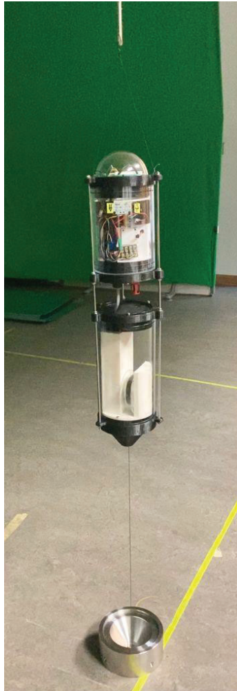
Figura 111 Prueba de funcionamiento completa del perfilador marino
