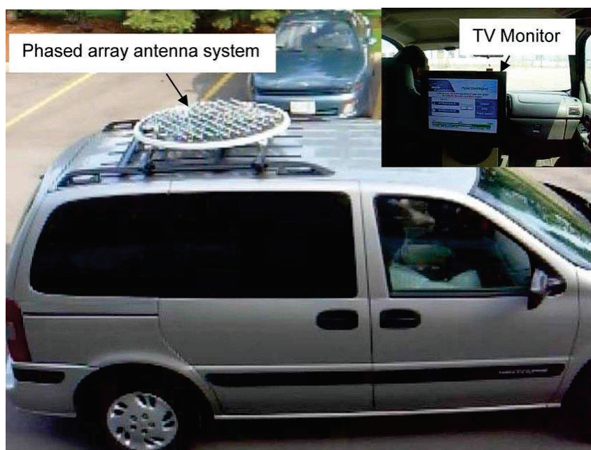
Figura 5. Ejemplo de array de antenas en fase montadas sobre vehículo [16].
