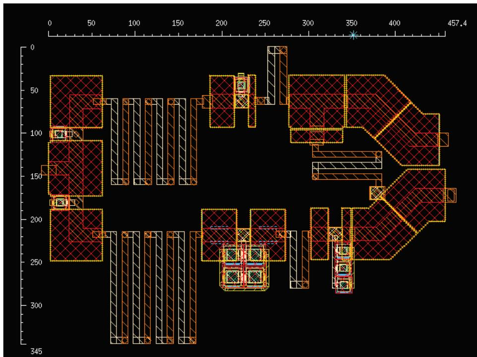
Figura 87. Layout del divisor de potencia Wilkinson en Cadence.
