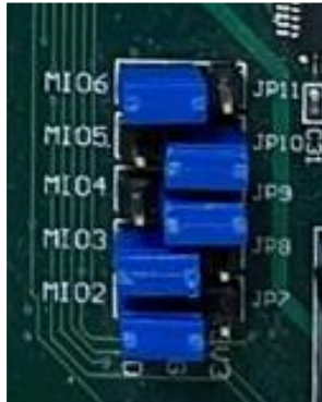
Figura 88. Configuración de los jumpers de la ZedBoard.
