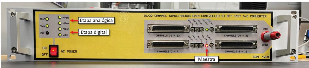
Figura 121. Encendido del módulo DAS.
