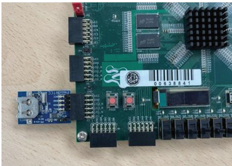
Figura 86. PMOD JC. Conexión del PMOD RTCC.
