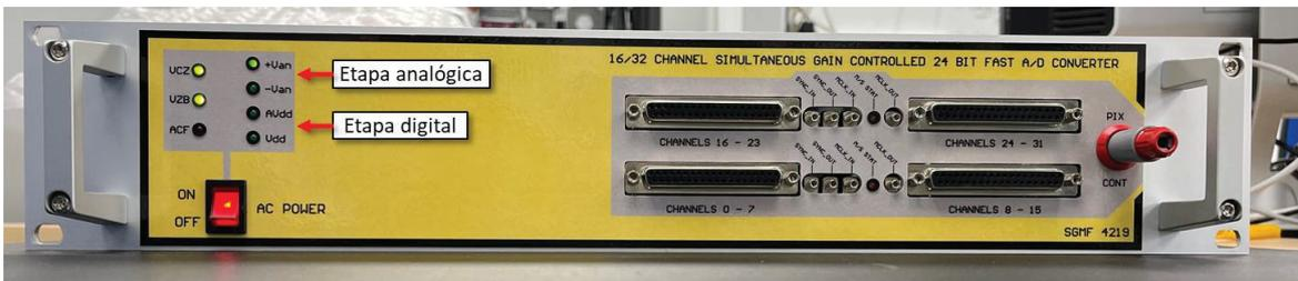
Figura 120. Apagado del módulo DAS.
