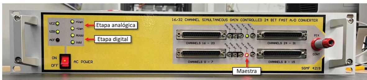
Figura 117. Módulo DAS configurado y arrancado.
