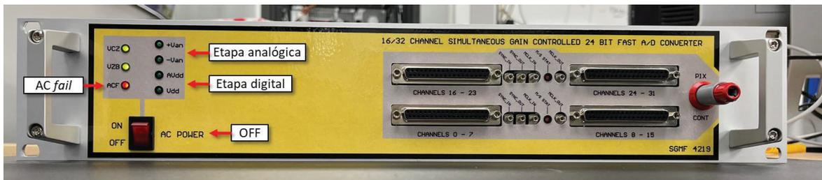
Figura 122. Apagado del módulo DAS por fallo en la fuente externa.
