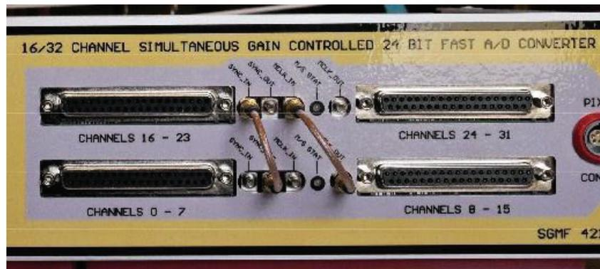
Figura 18. Frontal del módulo. Sincronización de tarjetas/módulos.
