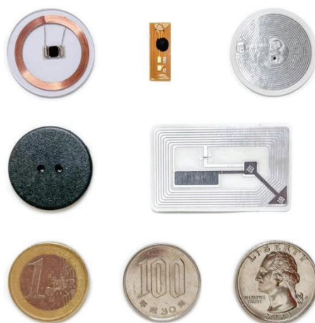
Ilustración 7: Algunos tags NFC en comparación con monedas y botones (NFC Forum, 2023)
