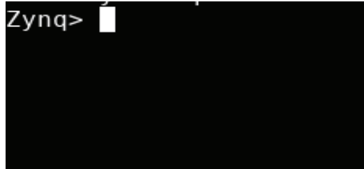
Figura 41. Arranque del sistema u-boot con el nombre Zynq en el prompt
