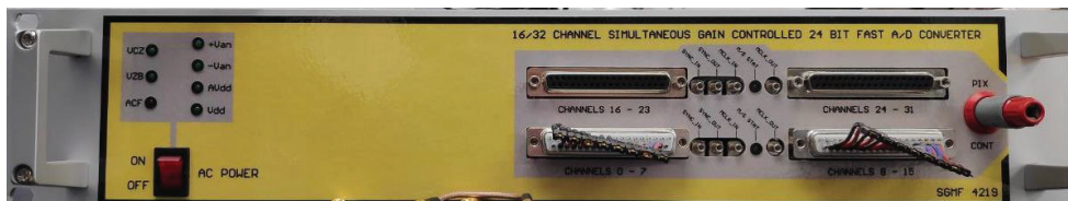
Figura 15. Conexiones frontales (puertos paralelos y conectores de sincronización)
