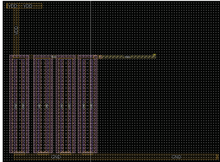
Figura 89. Red de puerta del cascode del LNA a nivel de layout.
