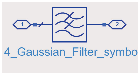
Figura 70: Símbolo del filtro gaussiano de 5to orden a 6 dB
