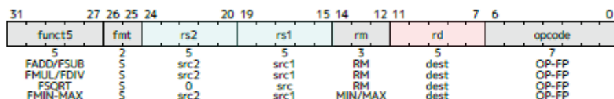
Figura 15. Instrucciones punto flotante de precisión simple
