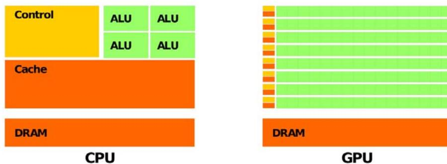
Figura 4.3. Arquitectura de una CPU y de una GPU. [NVIDIA]
