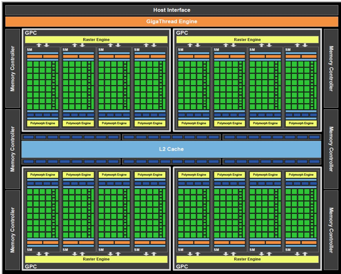
Figura 4.4. Arquitectura del chip GF100. [NVIDIA]
