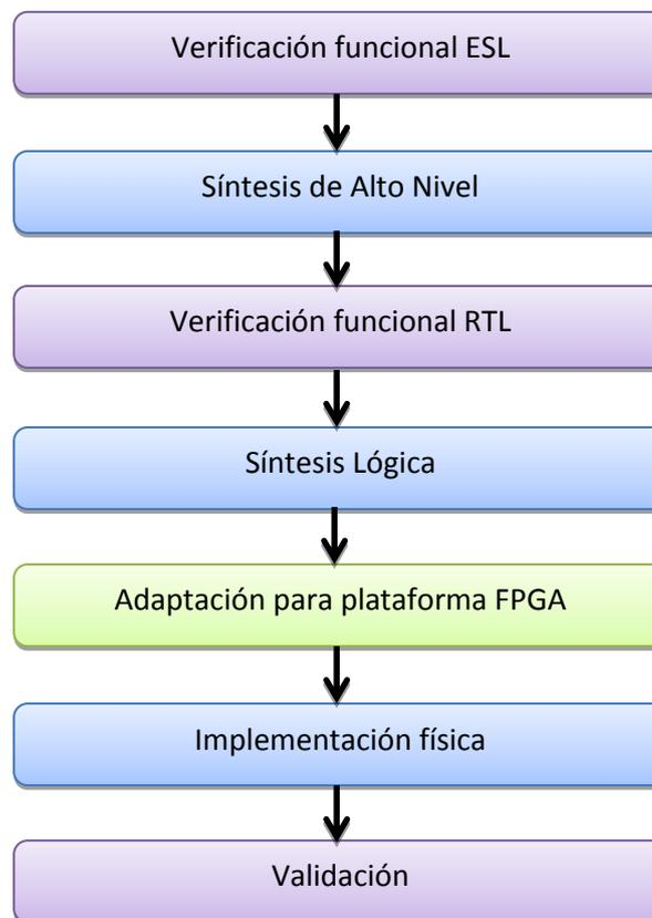
Figura 27. Flujo de diseño propuesto.
