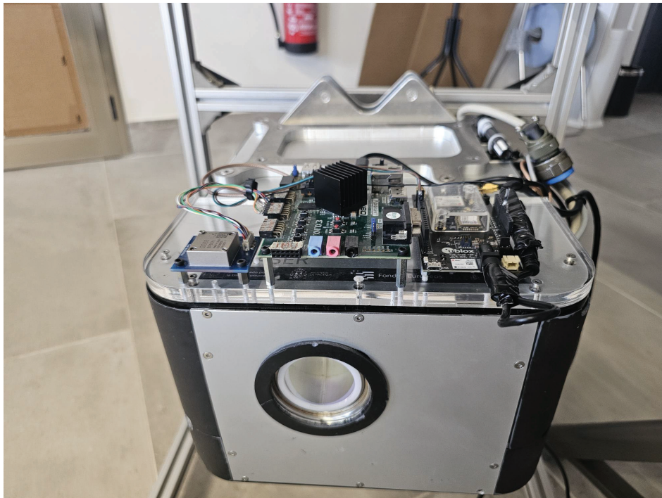
Figura 6.21: Integración del subsistema de sincronización GNSS/IMU sobre la carcasa superior del escáner LiDAR mediante soporte transparente mecanizado.
