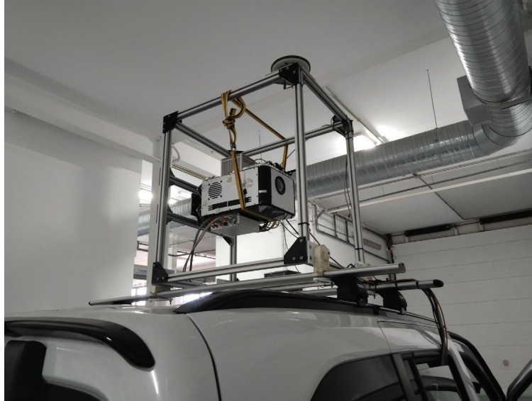
Figura 7.9: Sistema final de adquisición montado encima del vehículo.
